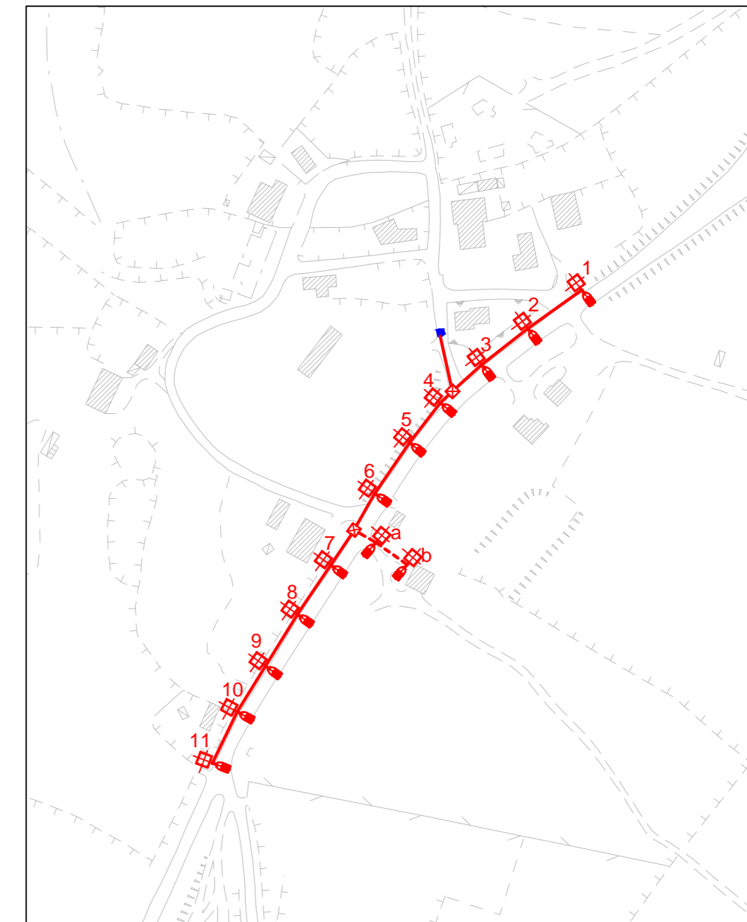
PLANIMETRIA IMPIANTO ILLUMINAZIONE PUBBLICA LOC. TRUDDA Scala 1: 2000
